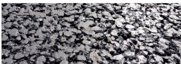
Figur 25. Nærbillede af et nyt og mindre støjende slidlag (teknisk betegnelse: SMA-8). Både den meget jævne og åbne overfladestruktur ses tydeligt. En traditionel belægning (f.eks. SMA-11) har en grovere og mere ujævn struktur.
