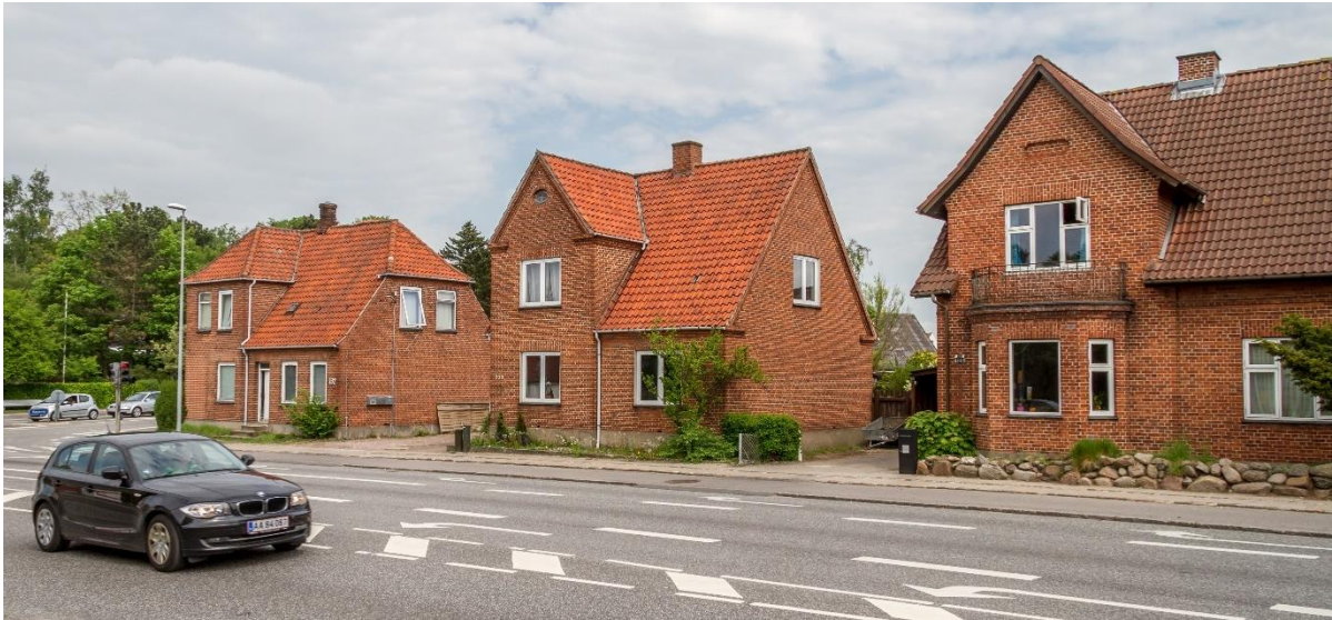
Figur 27. I mange tilfælde kan der ikke plads til en støjskærm langs vejen. Der kan også, som på billedet, være udkørsler fra boligerne, som vil blive blokeret af en støjskærm.
